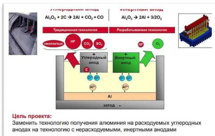
1. Компанией ОК РУСАЛ впервые в мире разработана уникальная технология получения «зеленого» алюминия с применением инертного анода, и уже сейчас проводятся испытания на промышленных мощностях. Главной целью технологии является сокращение углеродного следа – менее 0,01 тонны эквивалента CO<sub>2</sub> на тонну алюминия. Применение инертного материала катода позволит производить столько же кислорода, как 70 гектаров леса всего на 1
