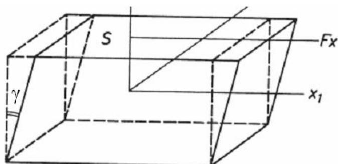
Рис.2. Возникновение деформации сдвига.
