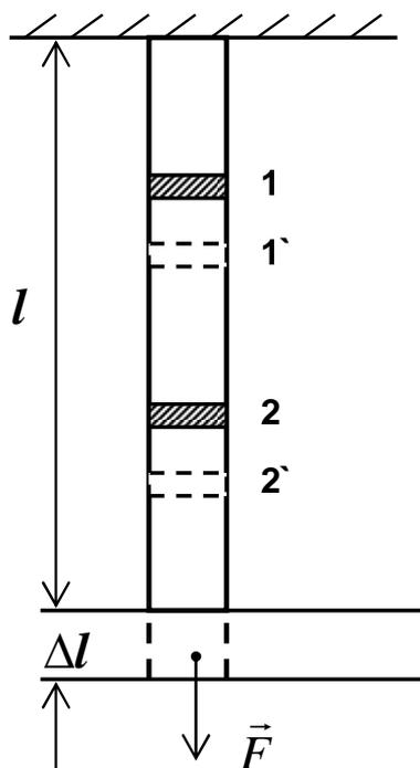
Рис.1. Схематичное изображение возникновения деформации растяжения однородного стержня под действием силы  $\vec{F}$ .
