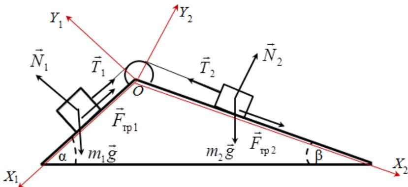
Рисунок 2.3 – Силы, действующие на тела при скольжении с учетом сил трения
