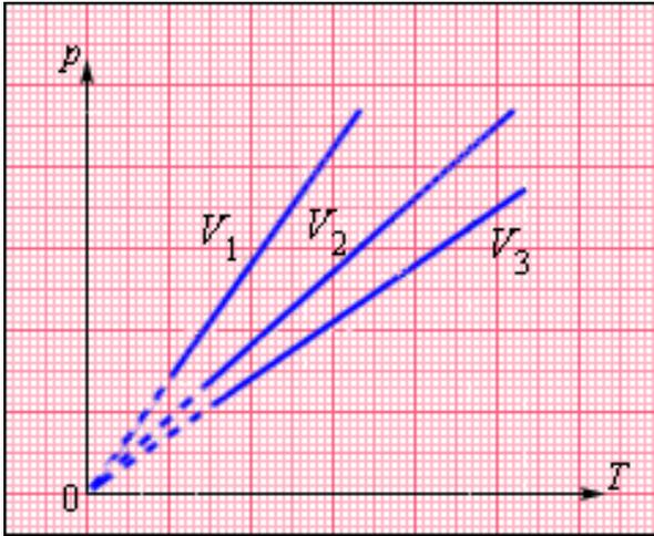
Рисунок 6.2 – Семейство изохор на плоскости  $(p, T)$ ;
