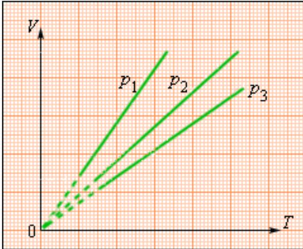
Рисунок 6.3 – Семейство изобар на плоскости  $(V, T)$ ;
