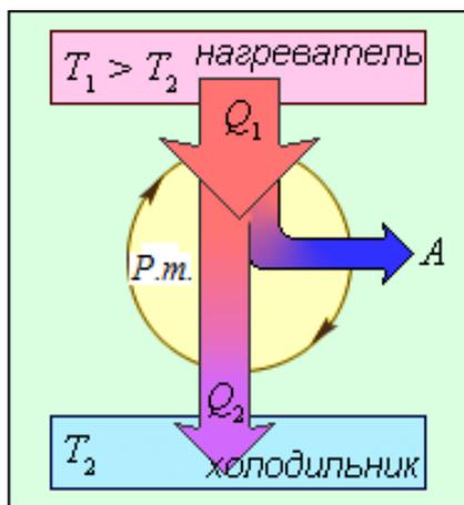
Рисунок 7.3 – Энергетическая схема тепловой машины: *P.m.* – рабочее тело
