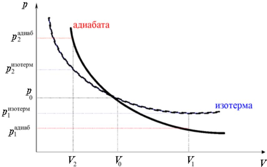
Рисунок 7.1 – Сравнение изотермы и адиабаты
