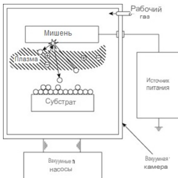
Рисунок 25 - Основной процесс напыления
