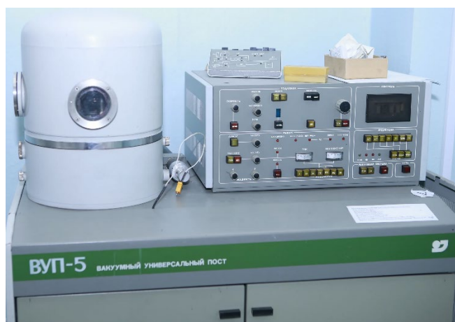
Рисунок 26 – Установка вакуумно-универсального поста ВУП-5
