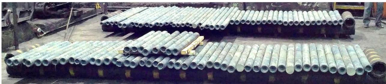
Рисунок 2.5 – Общий вид деформированных на стане РСР МИСиС-130Т заготовок.
