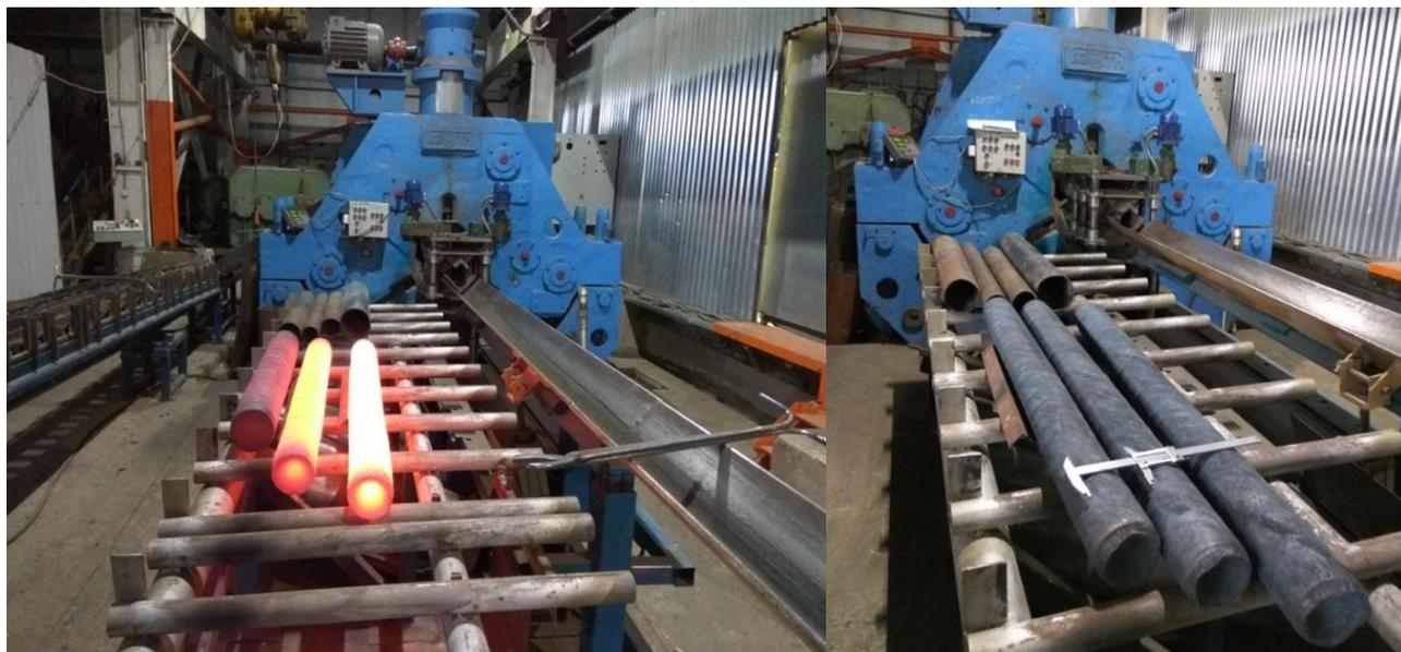
Рисунок 2.2 – Непрерывнолитая заготовка производства АО «ПНТЗ» после прокатки на выходной стороне стана МИСиС-130Т.
