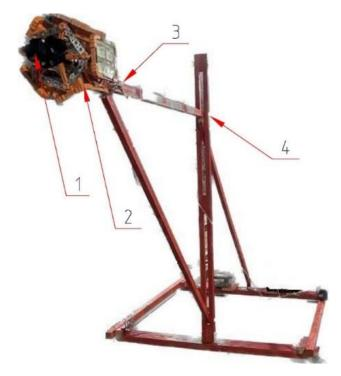
Рисунок 1 - Компоненты ПТФС: 1 — панорамная фотокамера; 2 — светодиодные прожекторы; 3 — аккумулятор для питания осветительных приборов; 4 — опорная колесная рама
