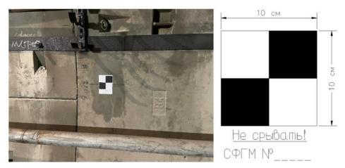
Рисунок 3 - Установленная СФГМ на обделке тоннеля (слева) и её габаритные размеры (справа)
