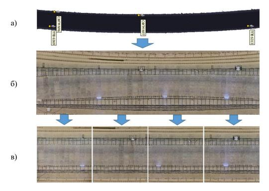
Рисунок 17 - Разбиение 50-метровой зоны криволинейного участка с радиусом поворота R=350м на секции: а) ЦМТ; б) ЦКТ с искажениями; в) 12.5-метровые секции ЦКТ без искажений
