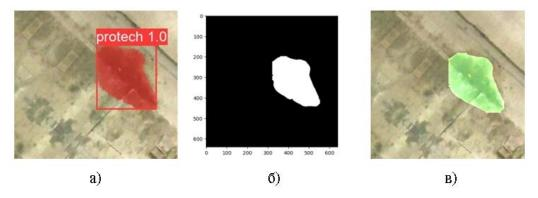
Рисунок 10 - Результаты детекции и сегментирования следов протечки: а) геоизображение на выходе из нейронной сети с присвоением класса и вероятностью идентификации; б) бинарная маска сегментированного дефекта; в) наложение маски на дефект.
