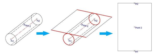
Рисунок 7 - Последовательность создания ЦКТ а) расположение маркеров на исследуемом участке; б) развертка поверхности цилиндра на горизонтальную плоскость; в) границы построения ЦКТ
