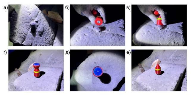
Рисунок 4 - Схема установленного ТПВ на пункте подземной полигонометрии: а) общий вид на центр полигонометрического знака; б) нижний магнитный блок ТПВ; в) подпружиненный шпинтель-центрир; г) установка накладного круглого уровня; д) установка ТПВ в вертикальное положение по круглому уровню; е) общий вид установленного ТПВ
