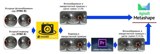
Рисунок 6 - Последовательность трансформации исходных пространственных данных
