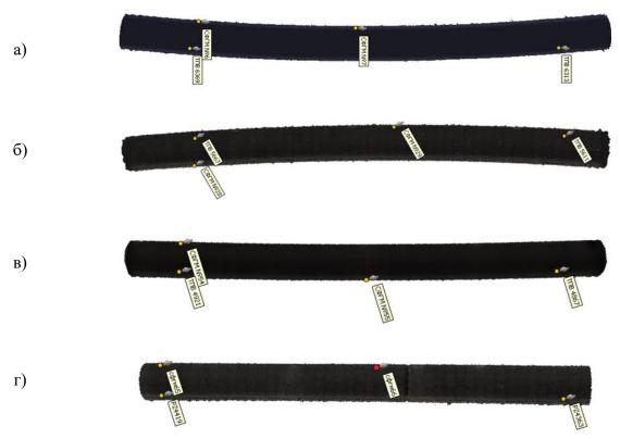
Рисунок 15 - Построенные ЦМТ 50-метровых участков перегонного тоннеля с опорными знаками: а) R=350м; б) R=500м; в) R=1000м; г) R=3000м
