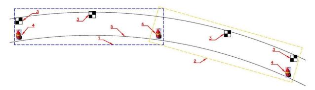
Рисунок 12 - Схема расположения опорных знаков на криволинейных участках перегонного тоннеля: 1 и 2 — смежные 50-метровыве зоны построения ЦМТ; 3 — закрепленные СФГМ на тюбинговой обделке; 4 — установленные ТПВ на полигонометрических знаках; 5 — конструкции перегонного тоннеля
