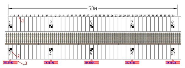
Рисунок 5 - Фрагмент установленных СФГМ на 50-метровом участке перегонного тоннеля: 1 – номер кольца исследуемого участка; 2 – СФГМ и её номер, 3 – пикетажное значение тюбингового кольца
