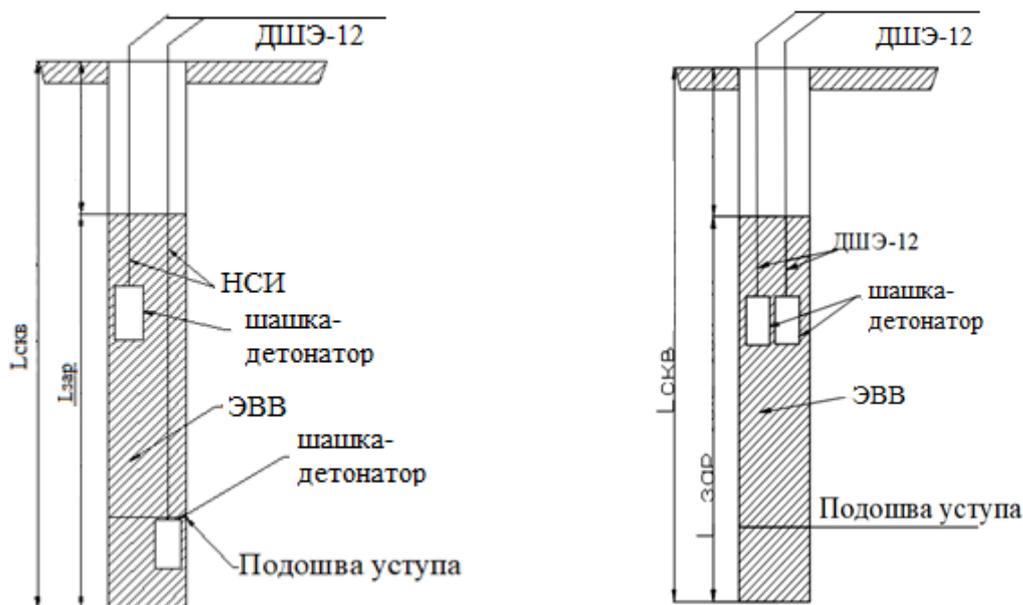
Рисунок 3 – Схема конструкции заряда ЭВВ, инициированного средствами инициирования а) НСИ в сочетании с ДШЭ-12; б) ДШЭ-12.
