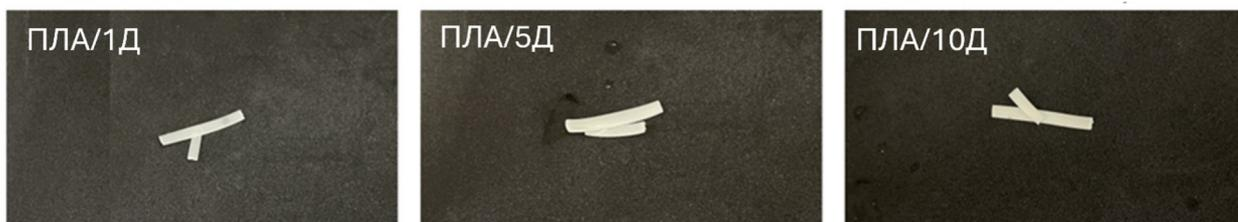
Рисунок 36 – U-shape тест композиционного материала ПЛА/Д с аморфно-ламеллярной структурой [137]
