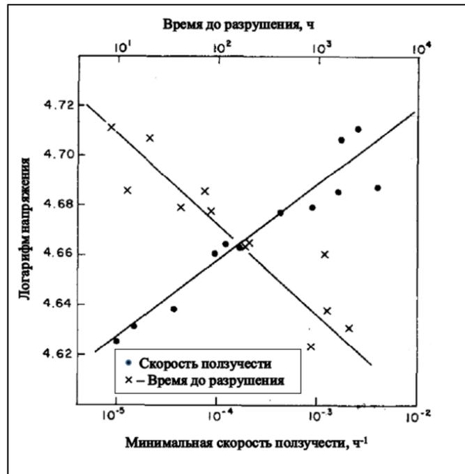
Рисунок 14 – Зависимость времени наступления ускоренной стадии ползучести от приложенных напряжений для сплава Zircaloy-2 [56]
