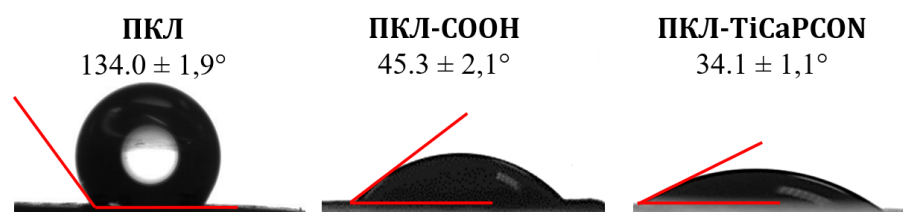
Рисунок 8 – Краевой угол смачивания исходных волокон ПКЛ, а также волокон ПКЛ с покрытиями
