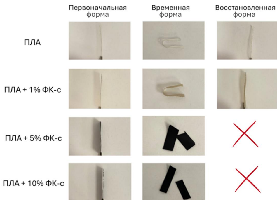
Рисунок 3.5 – Исследование ЭПФ композиционного материала ПЛА/ФК-т, полученного методом литья из раствора, с помощью «U-shape» теста [167]
