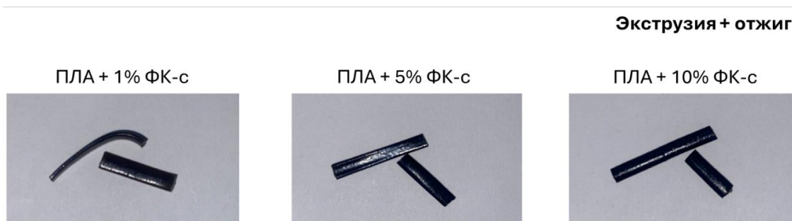
Рисунок 3.4 – Исследование ЭПФ экструдированного и отожженного композиционного материала ПЛА/ФК-с с помощью U-shape теста [167]
