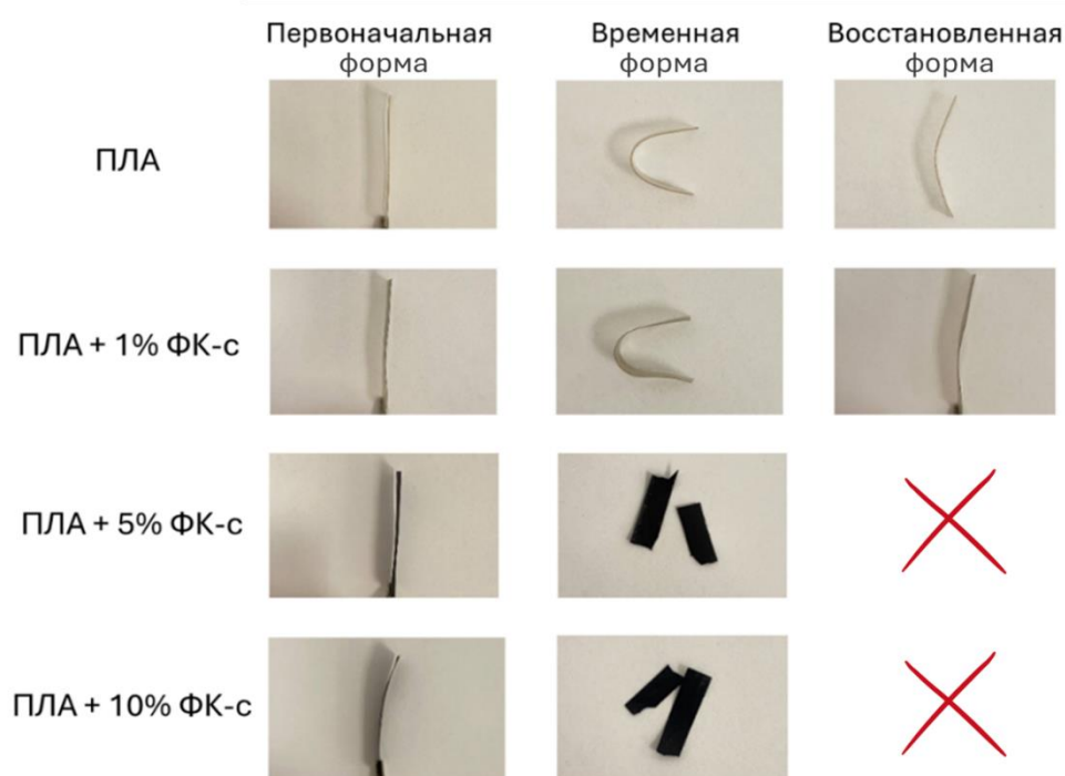
Рисунок 3.6 – Исследование ЭПФ композиционного материала ПЛА/ФК-т, полученного методом литья из раствора, после отжига выше T_{х.к.} с помощью «U-shape» теста [167]
