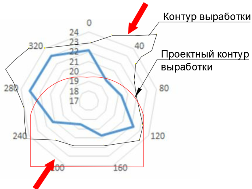
Рисунок 3.23 — Распределение амплитуды импульсов в 10 м от забоя автоуклона (сечение 2-2), (красные стрелки показывают направление повышенных напряжений)
