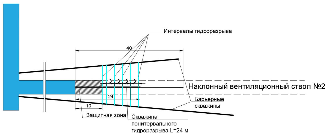
Рисунок 2.40 — Схема бурения скважины для поинтервального гидроразрыва в подготовительном забое вентиляционного ствола № 2
