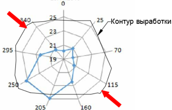
Рисунок 3.34 — Амплитудная диаграмма направленности ЕЭМИ в забое спирального съезда блока № 11 по контуру выработки после проведения БВР (красные стрелки показывают направление главных напряжений) (сечение 1-1)
