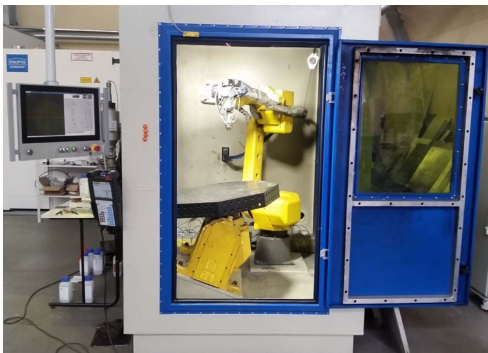
Рисунок 13 – Общий вид установки прямого лазерного выращивания
