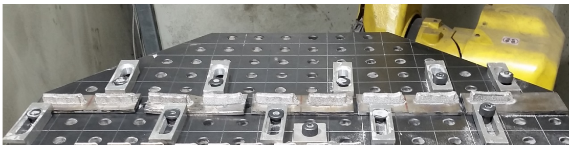
Рисунок 28 – Образцы, выращенные по режимам А.5.1–А.5.9
