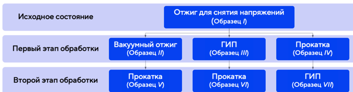
Рисунок 38 – Схема вариаций комбинирования способов постобработки
