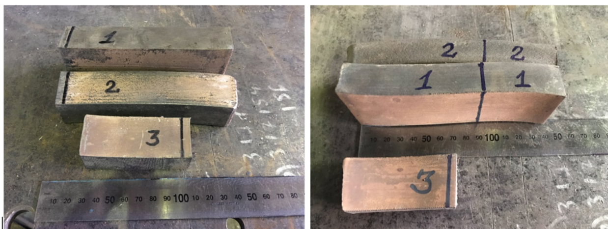
Рисунок 46 – Прокатанные образцы после первого (слева) и пятого (справа) проходов
