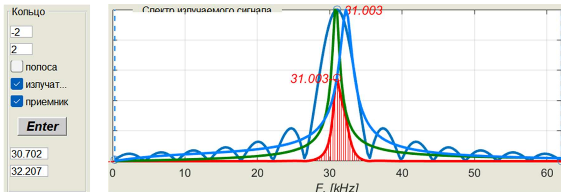
Рис. 4.7. Настройка полосы пропускания излучателя и приёмника
