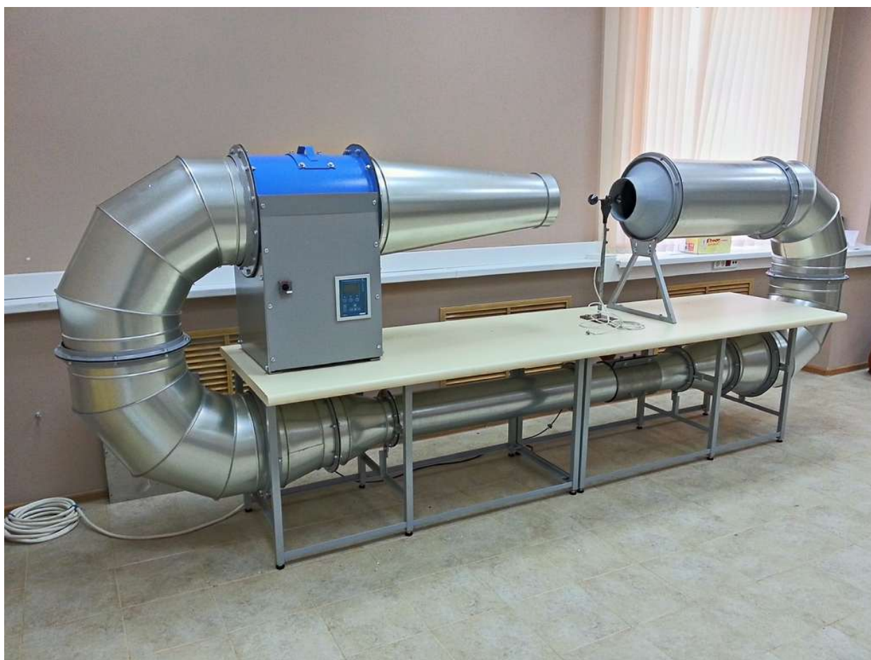
Рис.5.10 Установка аэродинамическая замкнутого типа А-02з
