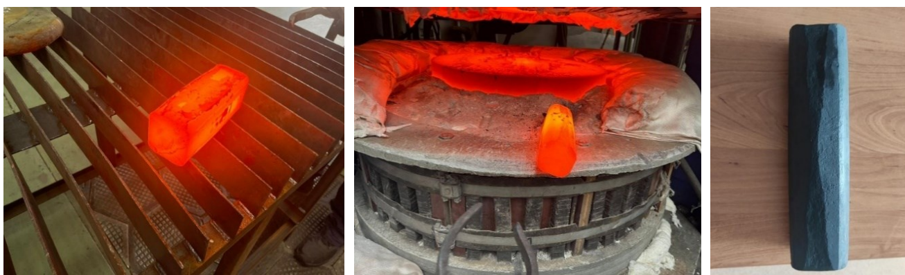
Рисунок 4.3 – Процессковки слитка из сплава системы Co-Cr-Mo (а, б) и внешний вид ковanej заготовки (в)
