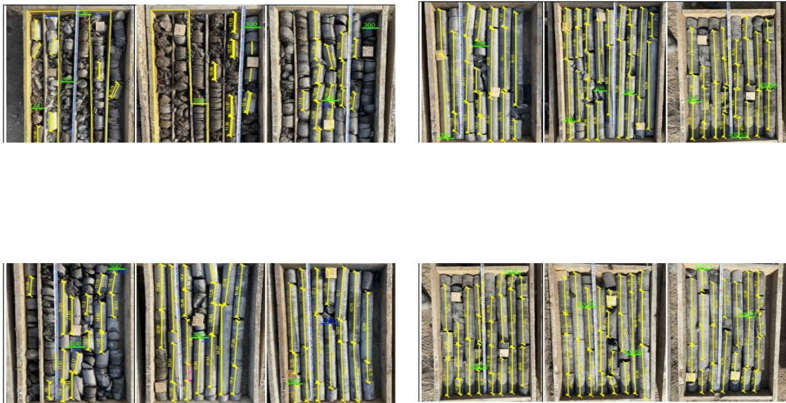
Рис. 2.9 – Визуализация учета качественной составляющей породы RQD
