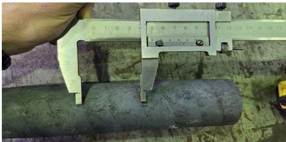
Рисунок 147. Шаг винтовой линии на поверхности прокатанного прутка
