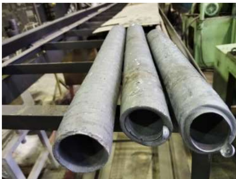
Рисунок 149. Торцы гильз: оценка толщины стенки и качества внутренней поверхности
