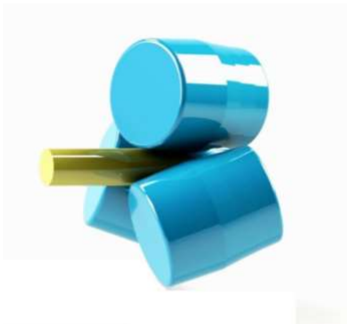
Рисунок 110. Сборка в SolidWorks для последующего моделирования прокатки заготовки в стане РСП 14-40 (для удобства отображения не показаны входные и выходные проводки)
