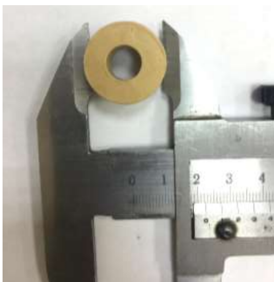
Рисунок 115. Гильза, полученная прошивкой в действующей модели: а – вид на цилиндрическую поверхность; б – со стороны торца.
