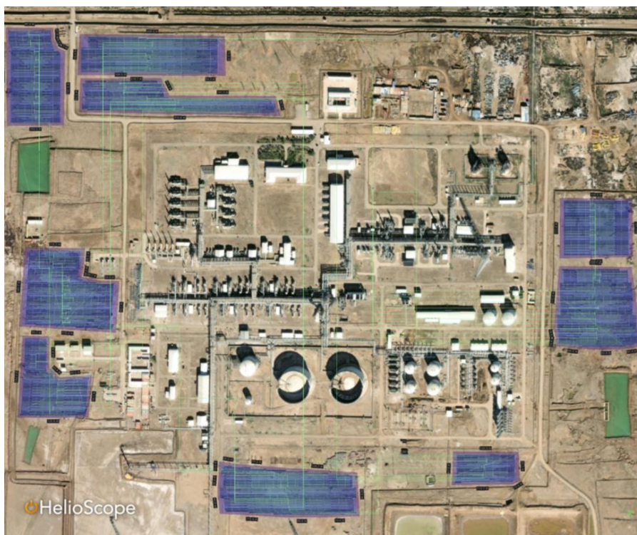
Рисунок 3.2 - Карта распределения и тепловая карта затенения сегментов поля солнечных модулей в исследуемой области
